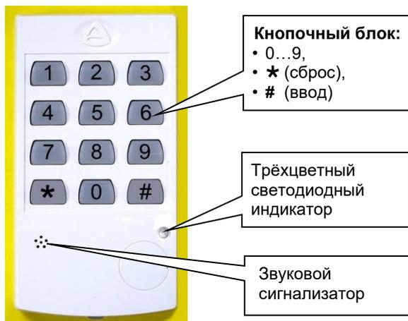
Для дистанционного управления прибором панель принимает введенную пользователем комбинацию цифр - код пользователя – четыре цифры. Затем нажимается кнопка «#» и кнопка с номером команды:
